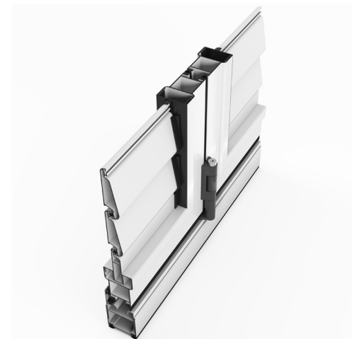
S35 MO Serie con persiana mallorquina de lama orientable y doble junta de estanqueidad, ideal para interiores o regiones climáticas templadas.
